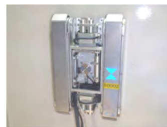
定型型水位測定装置
