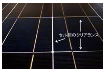
写真1 セル間のクリアランス
