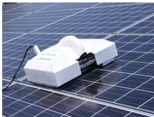
写真3 PV モジュール検査ロボットによる検査実施状況
