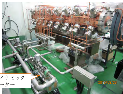
写真3 ダイナミックヒーターによる制御部
