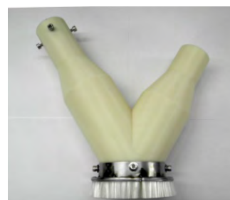
写真2 プロトタイプのブラストヘッド外観
