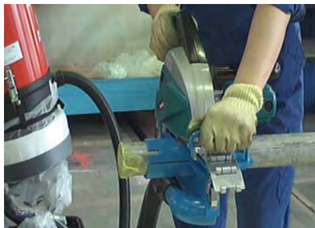
写真1 切断試験の様子[配管へのボックス取付前(左)、取付後(右)]
