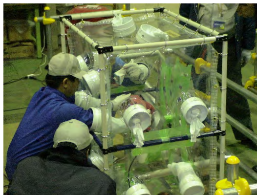
写真5 妥当性確認状況(バンドソーで配管切断中)
