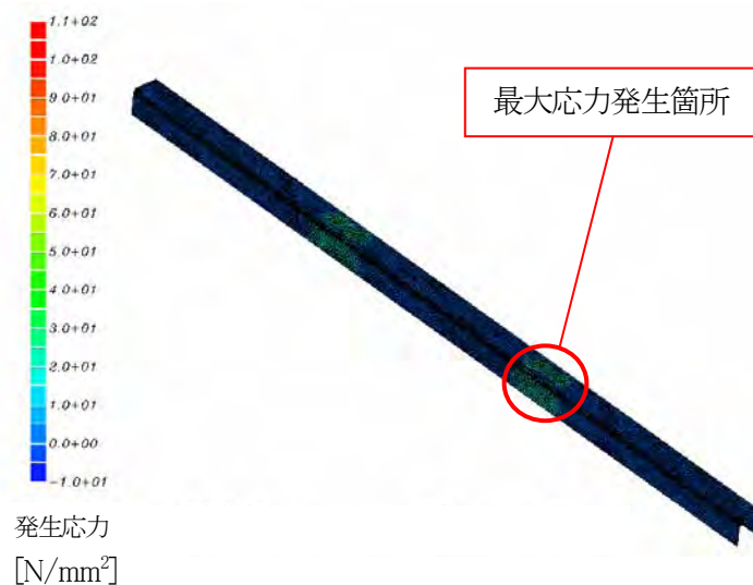
図1 プール土手の手摺設置面の強度評価
